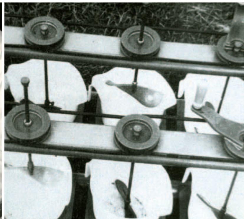
První z míchaček na odlepování jiker kapra. One of the first mixers for desticking the common carp eggs.
