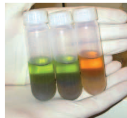
Extrakce tuku ze vzorků planktonu (vlevo) a metylestery mastných kyselin (FAME) připravené pro analýzu plynovou chromatografií (GC).
